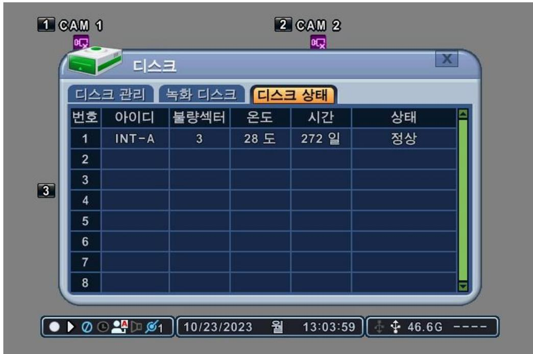
해당 탭은 디스크의 불량섹터/온도/HDD 동작시간 등의 디스크 정보를 표시합니다. 디스크 정보는 HDD의 제조사 별 차이가 발생할 수 있으며, “불량섹터” 혹은 “경고 문구” 발생 시 - 구입처에 문의 하셔서 디스크 교체를 받으시기 바랍니다.
